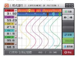
把温度, 湿度的PV, SP, MV实时表示及储存在内部存储器里 ▶代替数码纪录
